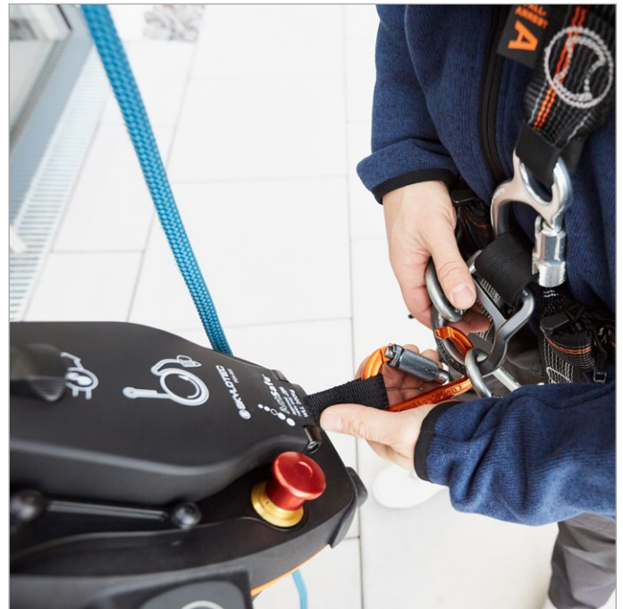
Connecting the ACX to the sit harness according to EN 813 (e. g. IGNITE ARGON, RECORD CACH or RESCUE PRO 2.0 with SKYBOARD) / Verbindung des ACX mit dem Sitzgurt gemäß EN 813 (z. B. IGNITE ARGON, RECORD CACH oder RESCUE PRO 2.0 mit SKYBOARD)
