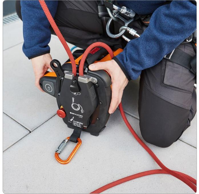
Inserting the semi-static working rope (SUPER STATIC 11.0) into the ACX POWER ASCENDER / Einlegen des halbstatistischen Arbeitsseiles (SUPER STATIC 11.0) in den ACX POWER ASCENDER
